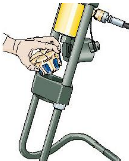
Obrázek 3-5 Vytažení přídržovacího kolíku a vložení sady čelistí
