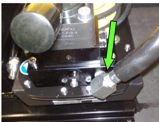
Obrázek 4-4 Připojení hadicového vedení
