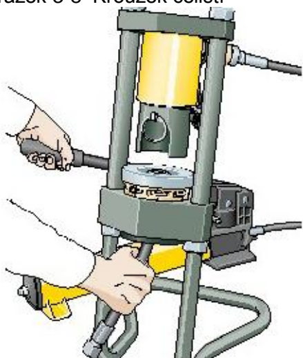
Obrázek 3-9 Zahájení procesu lisování
