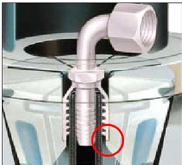
Obrázek 3-7 Umístění na doraz čelistí
