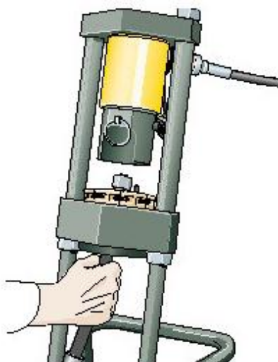
Obrázek 3-6 Vložení a umístění koncovky
