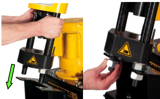
Obrázek 4-3 Montáž lisovací hlavy
